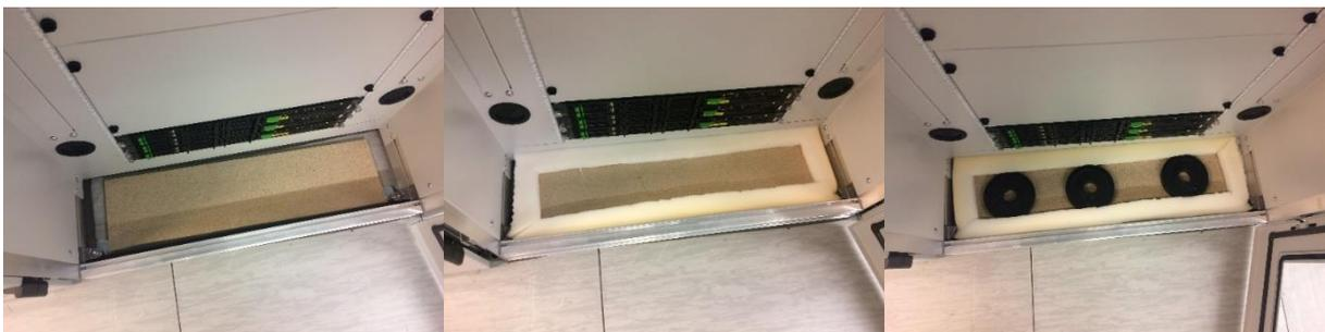
**Abbildung 94: Abdichtungsversuche mit (v. l. n. r) Brett, Brett mit Schaumstoffummantelung, Brett mit Schaumstoffummantelung und zusätzlich erschwert**
