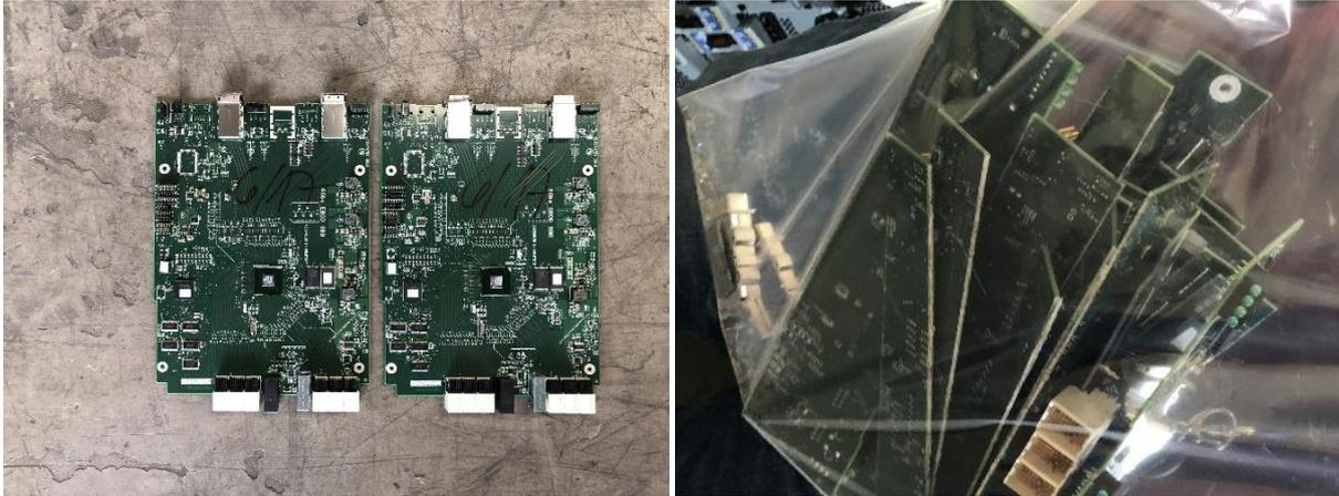
Abbildung 11: 'Minderwertige' Leiterplatten vor (links) und nach (rechts) dem Schneiden.
