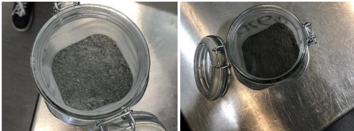
Abbildung 12: Zerkleinerungsfraktion auf 4 mm (links) und 2 mm (rechts).
