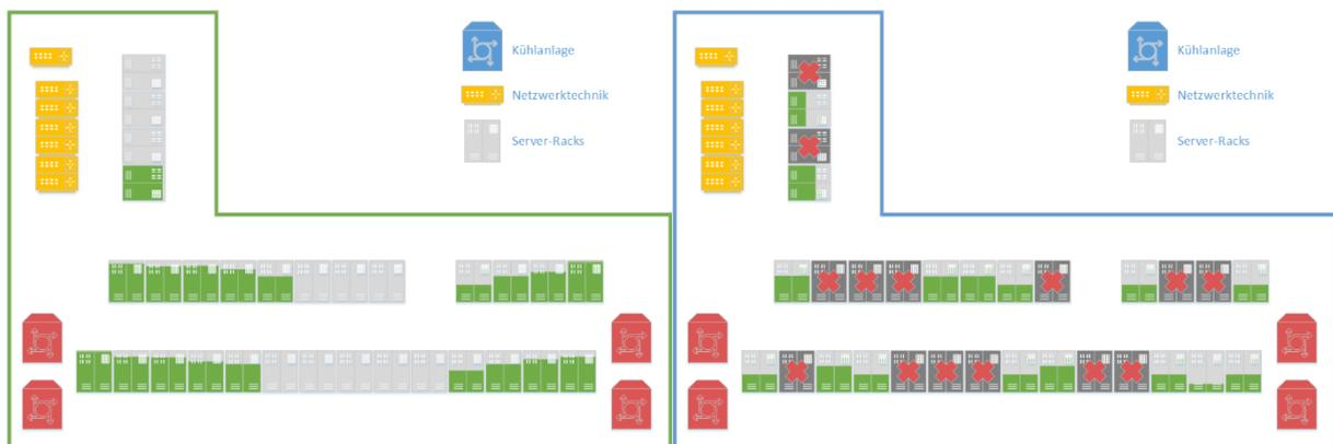
Abbildung 90: Beispielhafte Darstellung der Strategien „VMs in die Nähe der Kühlanlagen verschieben“ (links) und „Abschaltung von nicht-priorisierten VMs / Hosts“ (rechts)
